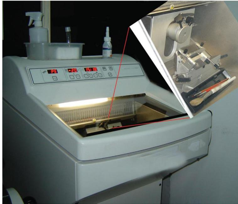
**FIGURA 3.3** Crióstato. Este equipo permite realizar cortes por congelación (obsérvese en la pantalla que los cortes se realizan a  $-20\text{ }^{\circ}\text{C}$ ). En el inserto se aprecia el detalle del soporte en el que se pega el tejido (encima del equipo se puede observar el frasco del pegamento) y la posición de la navaja que realiza el corte, el cual se recoge con un pincel.
