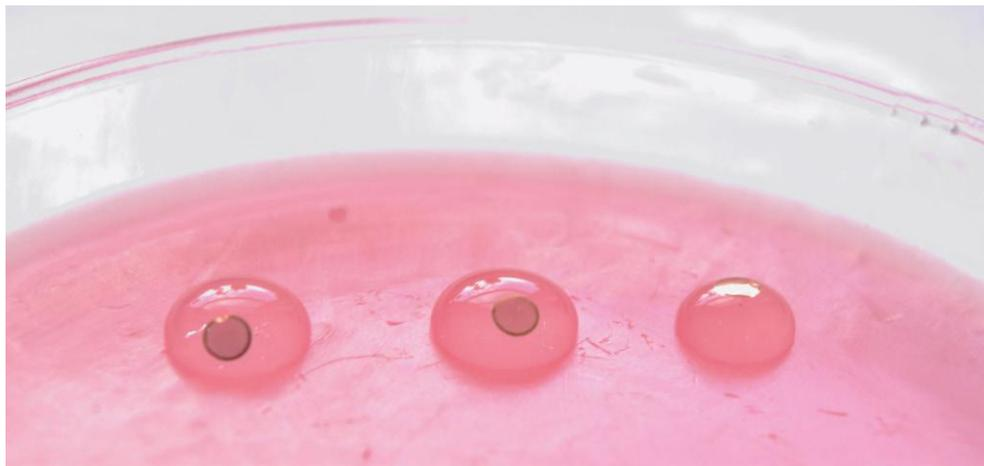
**FIGURA 3.7** Coloración del corte para microscopía electrónica. El corte está sobre la grilla y, en este caso, la coloración se hace apoyando la cara de la grilla que sostiene el corte sobre gotas de acetato de uranilo y citrato de plomo.
